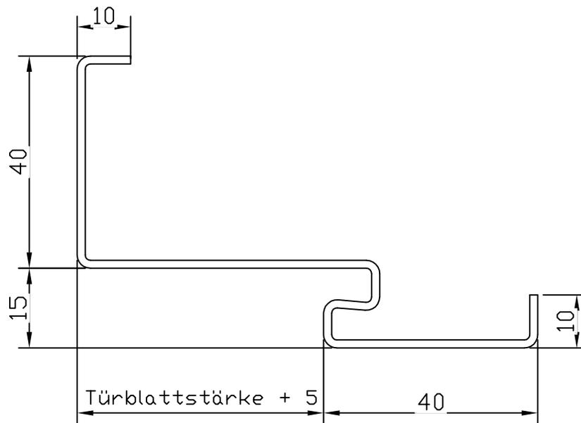
gedrückte Gummidichtung: 3mm
