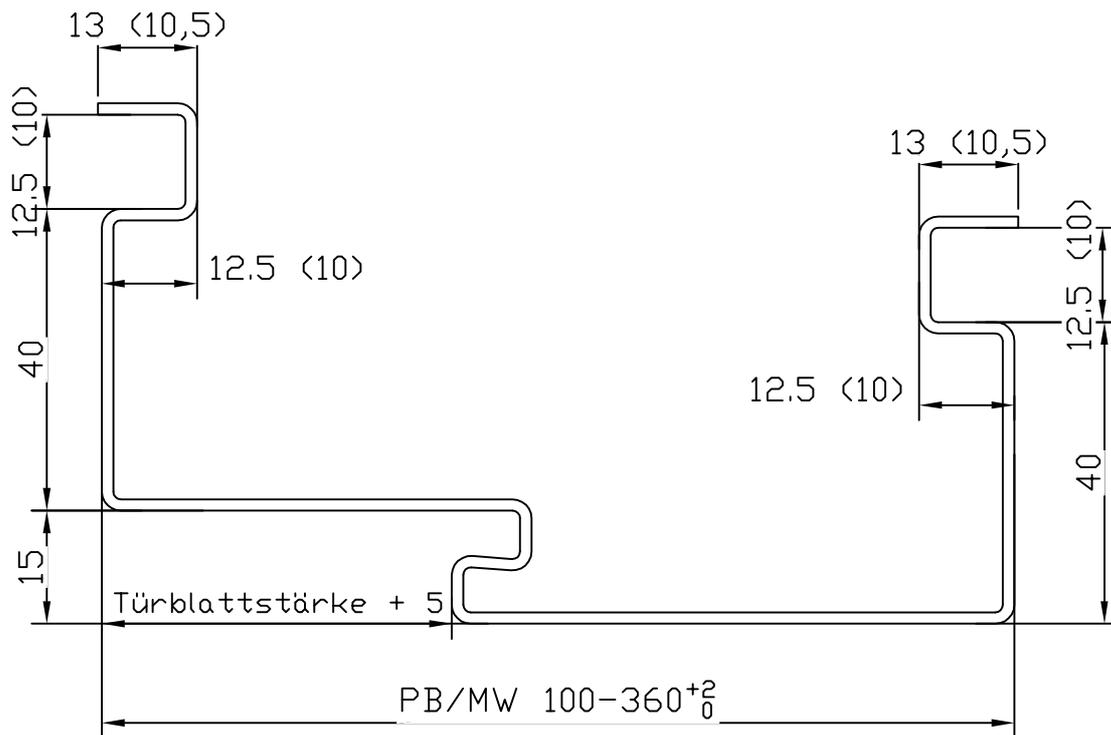
gedrückte Gummidichtung: 3mm
