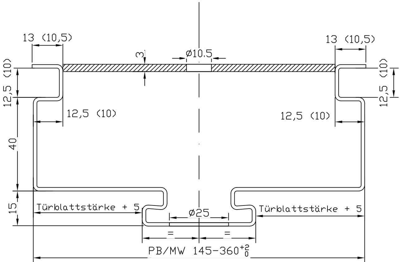
gedrückte Gummidichtung: 3mm
