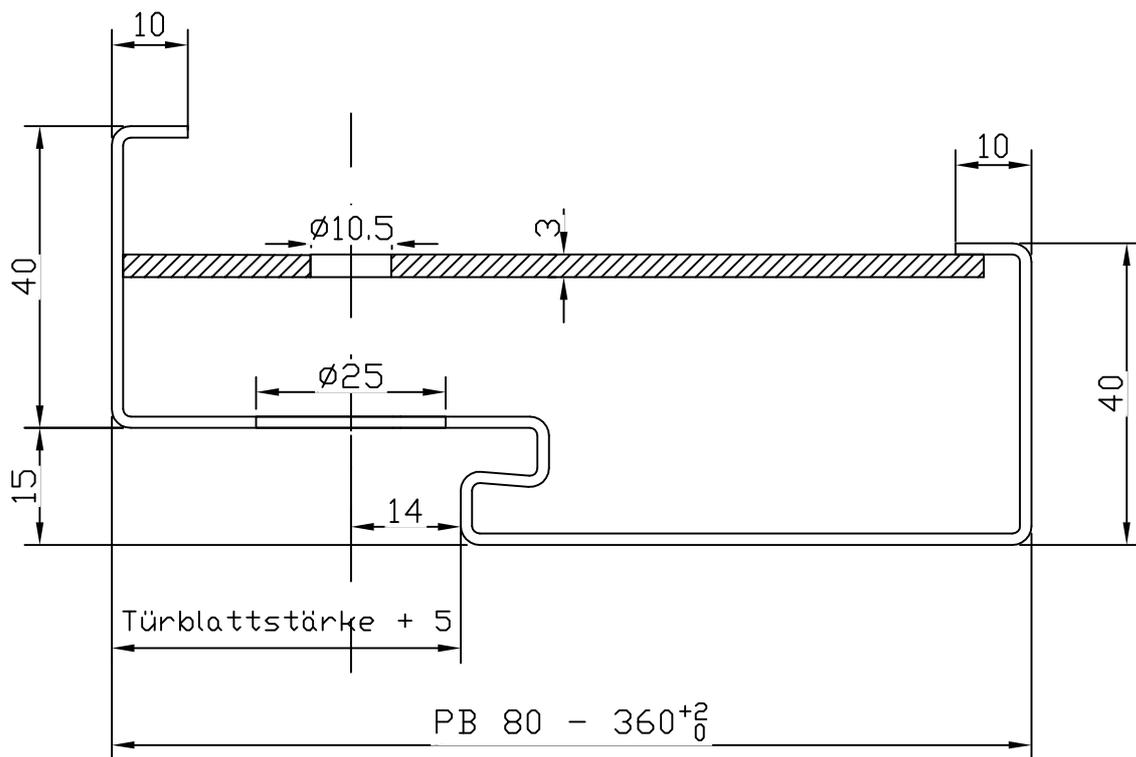
gedrückte Gummidichtung: 3mm
