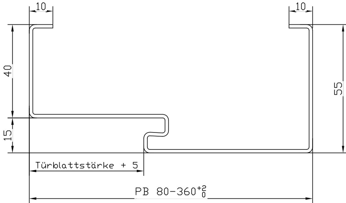
gedrückte Gummidichtung: 3mm
